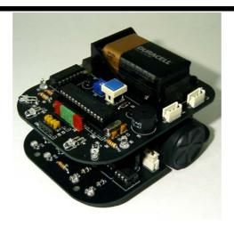
Le BasicBot est un robot mobile programmable qui exploite le microcontrôleur "PICBASIC-3B" du fabricant Comfile Technology. Sa programmation très simple en langage BASIC vous permettra de gérer ses 2 moteurs ainsi que l'ensemble de ses capteurs, lesquels offrent une multitude de combinaisons et possibilités de fonctionnement possibles.
